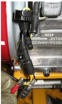
1 DESCONECTAR EL CABLE NEGRO DE LA BUJÍA
