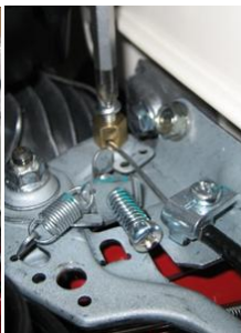
3 FIJAR LA SIRGA DEL ACELERADOR
