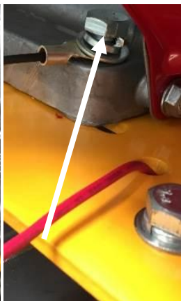
3 CONECTE O ATERRAMENTO AO PARAFUSO DO MOTOR
