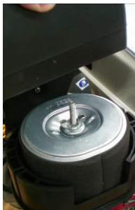
1 REMOVA A TAMPA DO FILTRO DE AR
