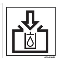
Wlew zbiornika oleju hydraulicznego
