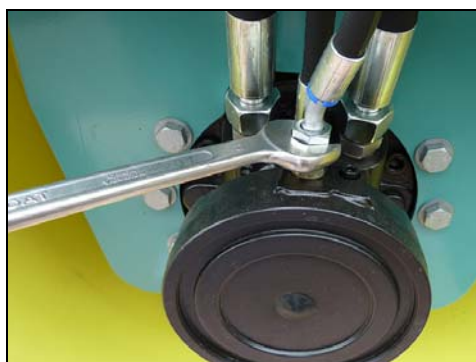
Fig. 9-32 Zdemontować przewód hamulcowy i zamknąć hermetycznie.
