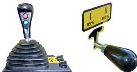
Fig. 7-5 Uruchomić silnik / pozycja dźwigni jazdy i dźwigni regulacji prędkości obrotowej
