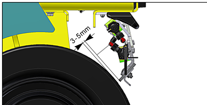
Fig. 9-26 Odległość od zgarniaka do osi kół pneumatycznych
