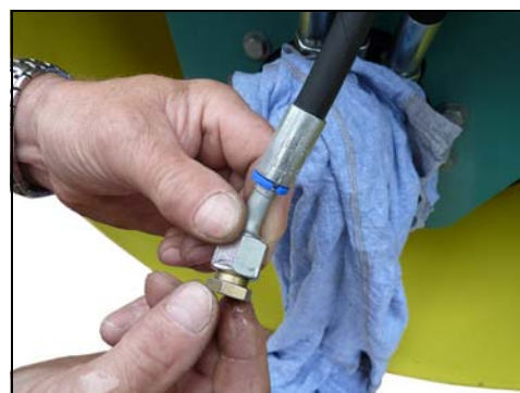
Fig. 9-32 Zdemontować przewód hamulcowy i zamknąć hermetycznie.
