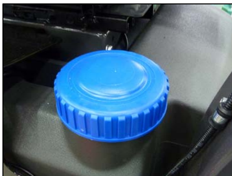
Fig. 7-6 Korek zbiornika wody z tyłu, z prawej strony
