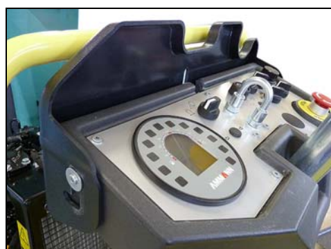
Fig. 7-4 Zabezpieczenie przed wandalizmem otwarte / zamknięte
