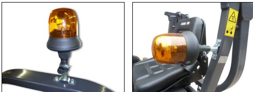
Fig. 8-4 Obrotowa lampa ostrzegawcza pracuje / nie pracuje
