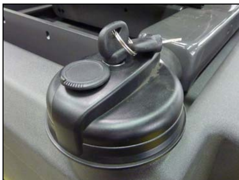
Fig. 8-9 Pokrywa zbiornika wody
