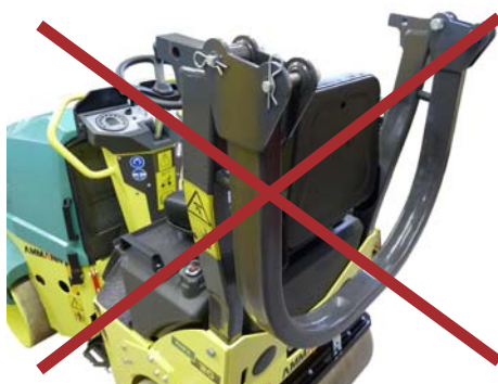
Fig. 3-2 Podczas pracy nigdy nie składać ROPS
