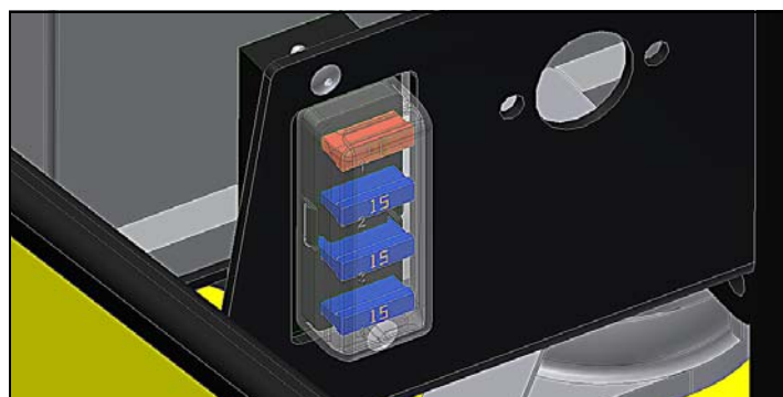
Fig. 10-4 Bezpieczniki w komorze silnika ARX 1
