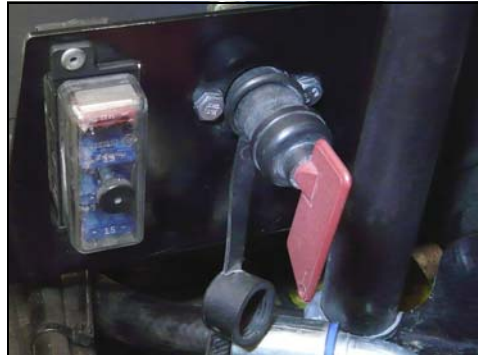
Fig. 8-11 Wyłączanie dopływu prądu
