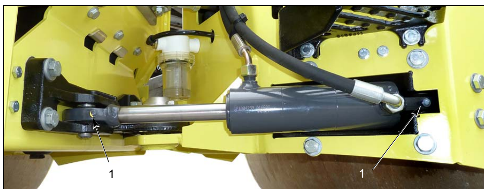
Fig. 9-33 Siłownik układu kierowniczego, pozycje wypustek smarowych
