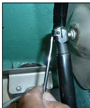
Fig. 10-9 Za pomocą wkrętka unieść klamrę i zwolnić sprężynę
