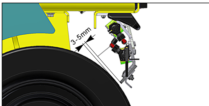
Fig. 9-24 Odległość od zgarniaka do osi kół pneumatycznych
